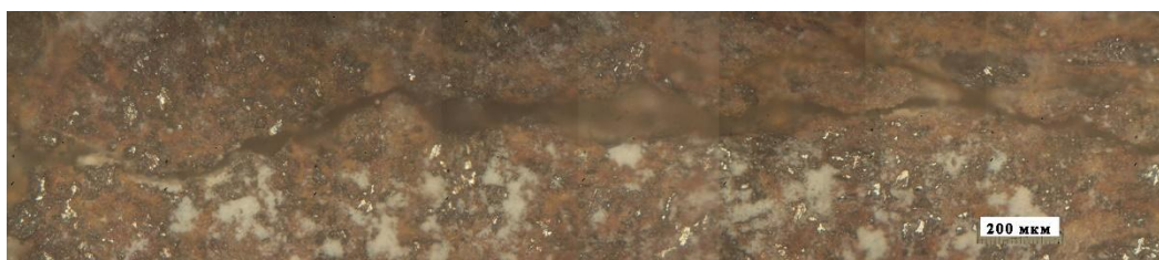
Рисунок 2. Трещина на поверхности образца кварцита, возникшая при взрыве: а – общий вид; б – участок трещины.
