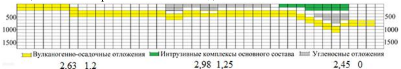
Рис. 2. Начальная плотностно-магнитная модель участка (первое число плотность в г/см 3 , второе число намагниченность в А/м)
