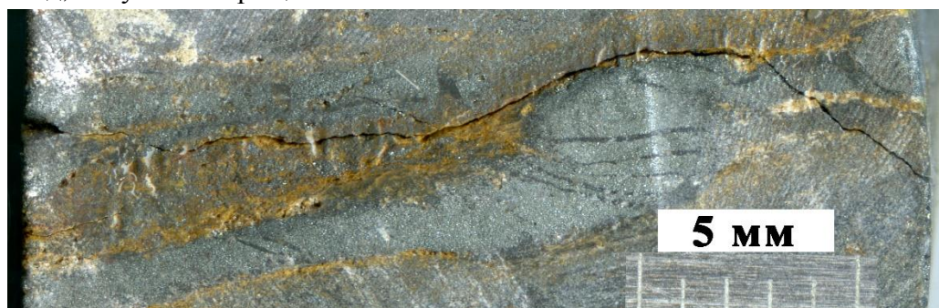
Рисунок 1. Трещина на поверхности образца гранита, возникшая при взрыве: а – общий вид; б – участок трещины.
