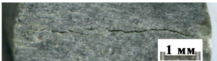
Рисунок 3. Трещина на поверхности образца нефрита, возникшая при взрыве: а – общий вид; б – участок трещины.
